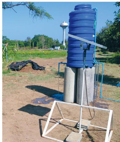
Bomba solar en el Centro Regional del Horticulture Innovation Lab en la Universidad de Kasetsart. Esta bomba puede permitir el riego por goteo en lugares alejados, donde el acceso a la electricidad, los altos costos de la obtención de combustible y la distancia de una fuente de agua puede hacer que el riego sea de difícil acceso para los pequeños agricultores.
